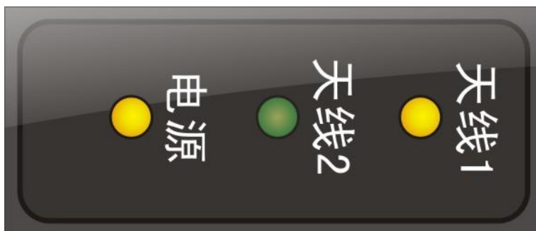
图 2-2 读写器 LED 指示灯面板示意图
