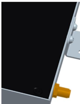
CL7205D 型天线预装有挂耳，挂耳孔径为 $\Phi 4.5\text{mm}$ ，可以通过螺丝，或是扎带穿过挂耳孔固定到承载物体上。
